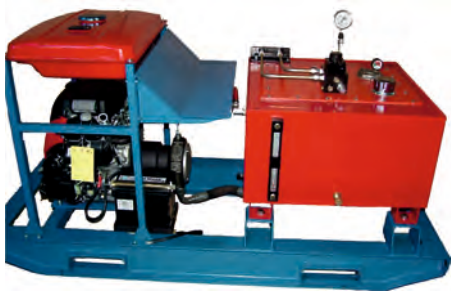
Модель: НБР-10П100-1 с электрозапуском бензодвигателя
