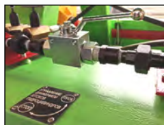
Шаровый кран 2-ходовой. Предназначен для аварийного сброса гидравлической жидкости из напорной в сливную магистраль
