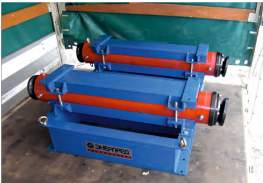
ЦС200Г1250Ш в составе установки для прокола грунта
