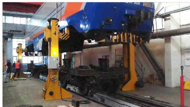
Домкратные установки применяются для подъема и удержания всех типов вагонов, полувагонов, локомотивов и т.д. в верхней позиции для получения доступа к демонтажу оборудования в подрамной зоне.
