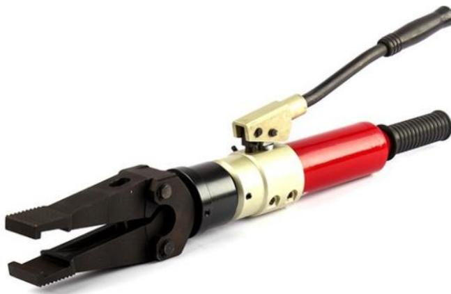
Домкрат клиновой гидравлический — компактный, легкий и простой в эксплуатации разжим, используется для выверки, выравнивания, точной установки грузов, при расширении узких проемов. К моделям КР1150 и КР2,5120 рекомендуется насос НРГ-7004А. Модель КРА1150 имеет встроенный насос.
