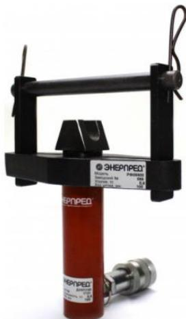
Гидравлический разгонщик фланцевых соединений - устройство, которое позволяет отказаться от устаревших методов разгонки фланцев трубопроводов при замене уплотнительных прокладок, установке заглушек, замене вентилей, клапанов на магистральных нефте- и газопроводах, теплоцентралях, сантехсистемах. Представленные в нашем каталоге модели имеют внешний или встроенный насос. Для моделей с внешним насосом рекомендуется использовать модель НРГ-7010.
