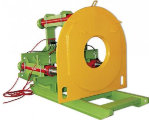
Установки бестраншейной прокладки труб - оборудование, предназначенное для прокладки трубопроводов под автомагистралями, железнодорожными насыпями, в условиях городской застройки. Обеспечивают высокую скорость и эффективность выполнения работ.
