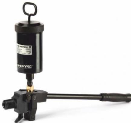
Инжектор масла предназначен для демонтажа гидрораспором деталей (подшипников, втулок, зубчатых колес и т. д.), имеющих посадки с натягом.
