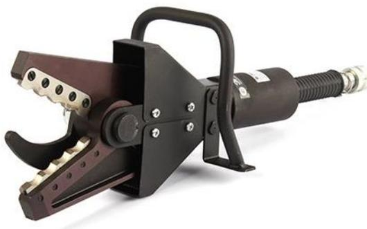
Гидравлические ножницы по металлу - оборудование, предназначенное для резки труб с толщиной стенки до 3 мм и листов металла толщиной до 5 мм и шириной не более 150 мм. Устройство может быть использовано для разрезания материалов: Ст3, Сталь 20. В качестве насоса рекомендуется использовать модель НРГ-7010.
