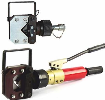
Инструмент предназначен для резки стальных уголков (горячекатаных равнополочных по ГОСТ 8509) и представлен в нескольких моделях. Модели НПА50 и НПА75 оснащены встроенным насосом. Надежную работу насоса, исключающую завоздушивание системы, обеспечивает маслбак из маслобензостойкой резины.
