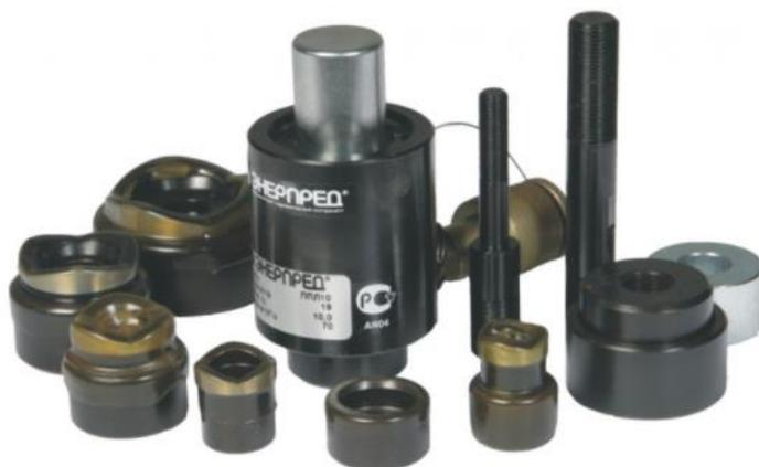
Перфораторы листовые предназначены для пробивания отверстий в листовом материале диаметром до 114,7 мм с максимальной точностью. Пробивка отверстия занимает минимальное время. Для пропуска тяговой шпильки необходимо предварительно сверлить отверстие. В комплект поставки пресса-перфоратора листового входит насос и рукав.
