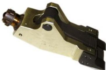
Специальная форма рычагов позволяет перемещать, раздвигать и приподнимать различные предметы при незначительном зазоре между опорой и грузом, работать в труднодоступных местах, обеспечивая большое усилие.
