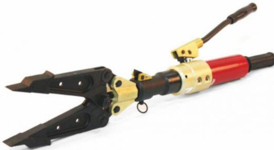
Аварийно-спасательный инструмент – комплект ручной универсальный гидравлический КРУГ-1С стоит на вооружении МЧС. Пять быстросменных насадок (разжим большой, разжим малый, разжим угловой, кусачки и ножницы) имеют возможность установки в четырех положениях, что позволяет выполнять работы в стесненных, труднодоступных местах.
