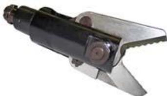
В комплект ручной универсальный гидравлический входят также ножницы Н-16, которые, как и кусачки, используются в качестве режущего инструмента, обеспечивая большее усилие резания. Предназначены для резки металлических прутков.
