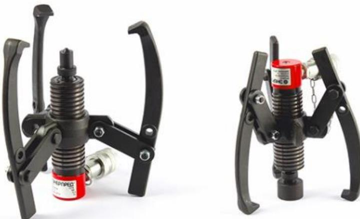
Съемник гидравлический трехлапый (также возможен вариант сборки с двумя лапами) предназначен для механизации различных ремонтных работ, разборки и демонтажа составных частей оборудования, имеющих посадки с натягом.
