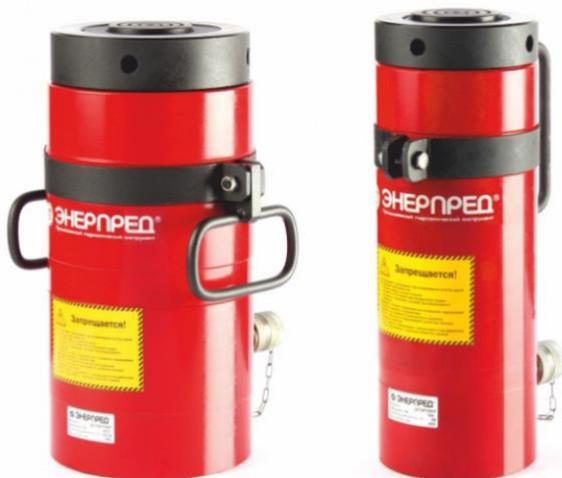
Гидравлический грузовой домкрат с фиксирующей гайкой снабжён безопасной системой механической поддержки груза: предохранительная гайка позволяет зафиксировать груз в поднятом положении на длительное время.
