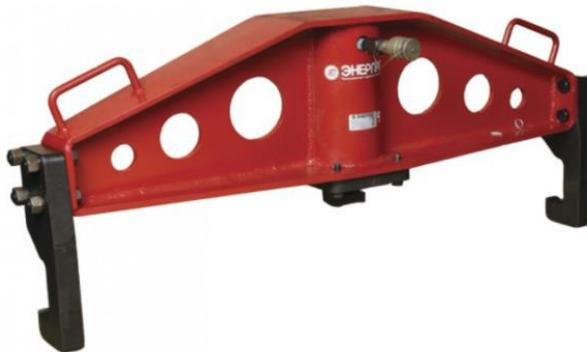
Рельсогиб гидравлический предназначен длягиба рельсов непосредственно на месте их укладки по необходимому профилю (на станционных участках, карьерах, горных выработках).
