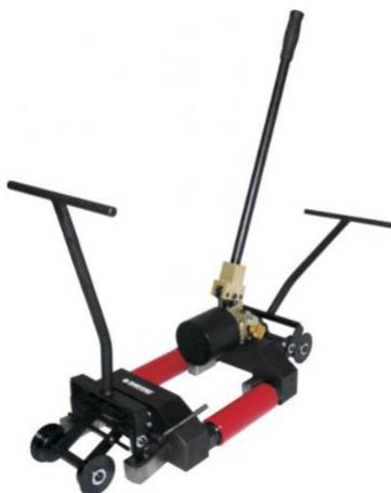
Гидравлический разгонщик – железнодорожный инструмент, предназначенный для продольной сдвижки рельсов или рельсовых плетей для восстановления нормальных зазоров между рельсами, нарушенными в результате угона пути подвижным составом.
