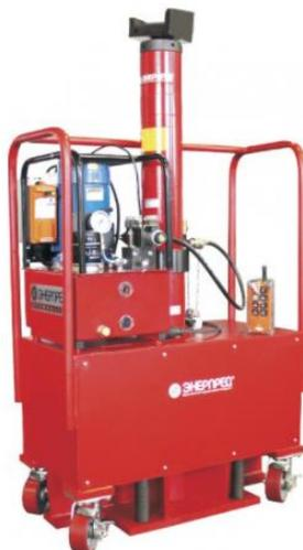
Домкраты передвижные предназначены для подъема локомотивов в условиях цеха при проведении ремонтных работ и технического обслуживания.
