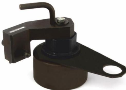
Приспособление обеспечивает откручивание проблемных торцевых гаек, закрученных с клеем-герметиком, с оси колесной пары железнодорожных вагонов. Применяется совместно с гайковертом ГКГ1000
