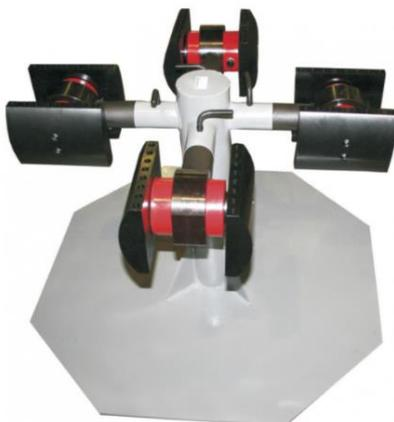
Установка для наплавки букс используется при проведении ремонтных работ узлов и деталей подвижного состава железных дорог и предназначена для стационарной наплавки посадочных мест буксовых узлов.
