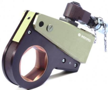
Гайковерт гидравлический кассетный - устройство для отвинчивания и завинчивания крепёжных деталей большого диаметра. Устройство применяется при работе в ограниченном пространстве (фланцевые соединения), когда шпилька или болт значительно выступают над гайкой. В каталоге представлены модели с различными техническими характеристиками, что наверняка позволит вам выбрать оптимальный вариант кассетного гайковерта с гидравлическим приводом.
